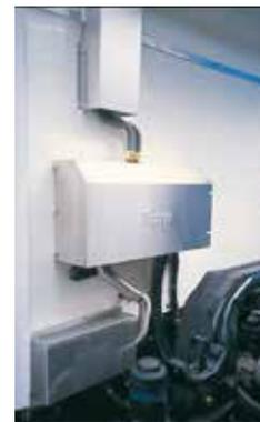
ラジエーター水ヒーター加熱装置
